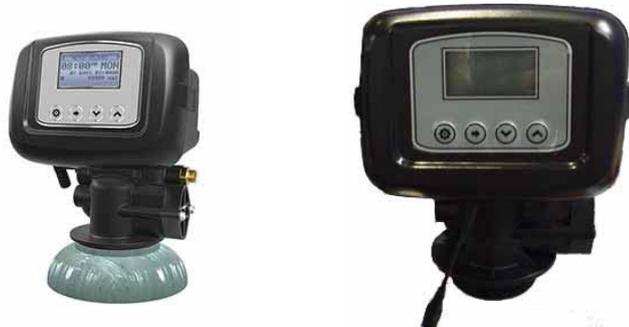
Valvola di controllo elettromeccanica serie TZ2, corpo valvola in plastica Noryl, ingresso/uscita da 1" o 3/4", rigenerazione Upflow (controcorrente), base di montaggio 2,5", portata di servizio 0,15 m<sup>3</sup>/H~3,5 m<sup>3</sup>/H (alimentazione continua, 0,35 Ingresso Mpa), adatto per serbatoi a pressione da 7 "a 16" (diametro), Imballaggio: cartoni da 6 pezzi. Dimensione del cartone è 0,58 \* 0,54 \* 0,26 (m)
