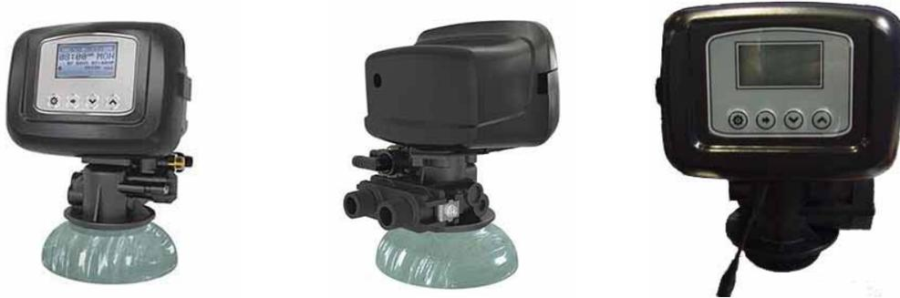
Valvola di controllo elettromeccanica serie EZ2, corpo valvola in plastica Noryl, ingresso/uscita da 1" o 3/4", rigenerazione Downflow (equicorrente), base di montaggio 2,5", portata di servizio 0,15 m<sup>3</sup>/H~3,5 m<sup>3</sup>/H (alimentazione continua, 0,35 Ingresso Mpa), adatto per serbatoi a pressione da 7 "a 16" (diametro), Imballaggio: cartoni da 6 pezzi. Dimensione del cartone è 0,58 \* 0,54 \* 0,26 (m)
