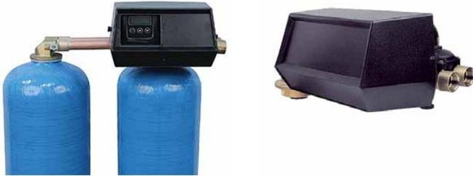
La 9000 è una valvola in ottone senza piombo, dotata di controllo a 5 cicli completamente regolabile, per un trattamento acqua efficiente e affidabile e con capacità di controlavaggio compatibili con serbatoi di addolcimento fino a 16". La rigenerazione avviene immediatamente quando serve per un flusso continuo di acqua addolcita, mantenendo l'impianto pulito per un'efficienza operativa ottimale e requisiti di manutenzione minimi.
