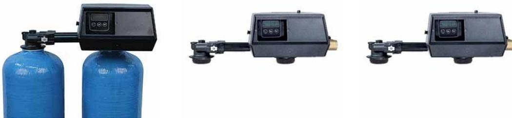
La 9100 è una valvola in materiale fibrorinforzato a matrice polimerica per una forza e una resistenza superiori. Non è soggetta a corrosione e resiste ai raggi UV, oltre a garantire una portata di servizio continua di 5,4 m3/h con controlavaggio di 2,3 m3/h. La rigenerazione della 9100 avviene immediatamente quando serve per un flusso continuo di acqua addolcita, mantenendo l'impianto pulito per un'efficienza operativa ottimale e requisiti di manutenzione minimi.
