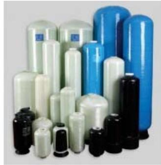
PVA - FRP Bombe con base Materiale : PE alimentare - Rinforzato fibra di vetro Colore Standard : Blu Certificazioni : NSF,D.M.174 - Ciclo di prova minimo : 250.000 cicli da 0 a 10 bar - Pressione massima d'esercizio: 10 Bar - Temperatura massima d'esercizio 45°C Sottovuoto max 140 mm Hg
