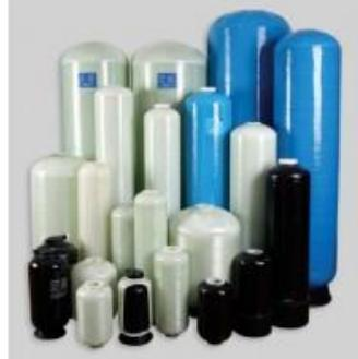
PVA - FRP-Drucktanks ohne Standfuß Material : PE lebensmittelecht - Glasfaserverstärkt Standardfarbe: Blau - Zertifizierung: NSF, TÜV - Mindestzyklustest: 250.000 Zyklen von 0 bis 10 bar - Max. Betriebsdruck: 150 psi (10 Bar) - Max. Betriebstemperatur: 45°C Max. Vakuum: 140 mm Hg.
